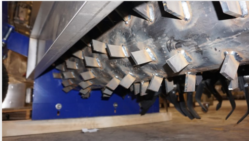
Rechenwalze zur Rückverfestigung und herstellen einer feinen Struktur für Sä- und Pflanzarbeiten
