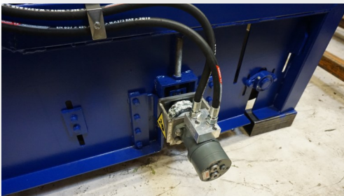
Rechenwalze mit Hydraulikmotor-Antrieb. Manuell höhenverstellbar.
