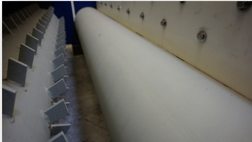
Glattwalze manuell höhenverstellbar. Erdabstreifer aus Kunststoff.
