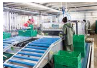
Die Anlage für den Pfälzer Gemüseanbaubetrieb Renner ist in der Lage, verschiedene Gemüse je nach Verschmutzungsgrad entsprechend zu reinigen und zu beschneiden
